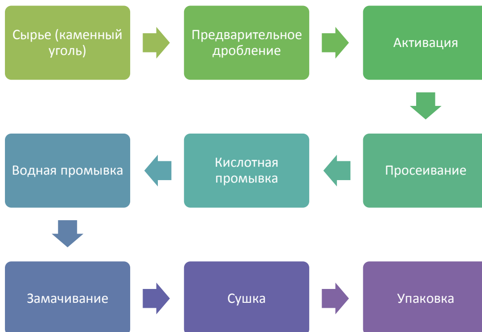
Рис. 5. Схема производства активированного угля
